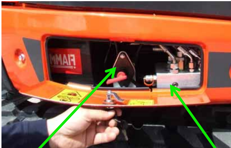
Hauptabschalter und Minihydraulikanschlüsse unter verschließbarer Klappe auf der linken Maschinenseite
